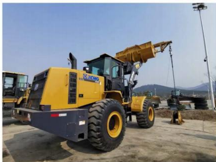
照片 F-2 最大提升高度提升能力测试
