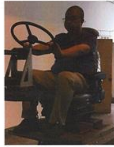
YHF-45型司机座椅样品EM6类输入振动试验照片 (左图试验人质量为56kg, 右图试验人质量为98kg)
