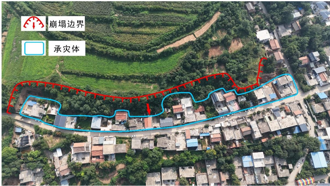
图 2-1 江兆村八组崩塌全貌（镜向 110°）
